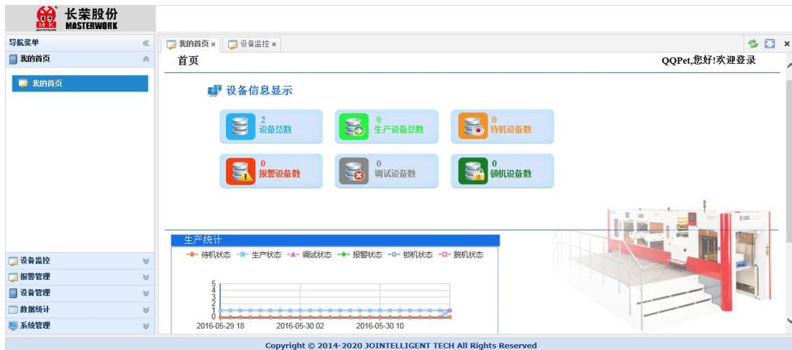
客户可以方便的将设备加入到云平台上,实现设备的联网管理。云平台上的联网设备将生产、运行数据上传到系统中,可实时监控速度、产量等设备当前的运行情况,还可以根据历史数据生成各种状态图、趋势图等,便于客户实时和真实地了解设备的运行状态、使用效率,便于及时发现生产中的问题并解决,为生产管理提供依据。
